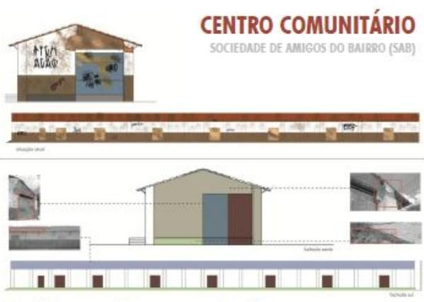
■ Paredes ■ Estrutura de concreto armado ■ Solos por meio de pilares e vigas de concreto ■ Esquadros ■ Cobertura de concreto armado
