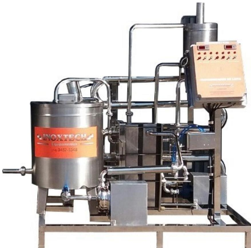
Figura 1.12 – Pasteurizador rápido a placas Inoxtech
