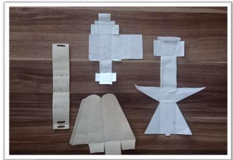
Figura 31 - Teste de facas de embalagens em escala reduzida - Foto: Autoral
