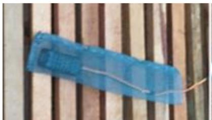
**Figura 2 – Sensor DHT 21 revestido com tela de fibra de vidro**
