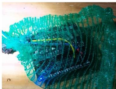
**Figura 1 – Esp8266 revestido com tela transparente**
