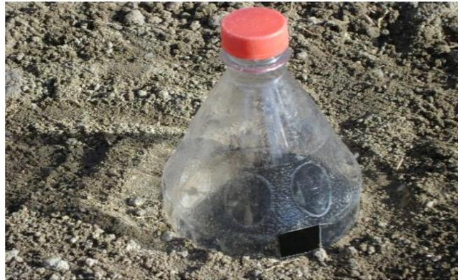
Figura 1. Armadilha adaptada do tipo PROVID para captação da macrofauna do solo.
