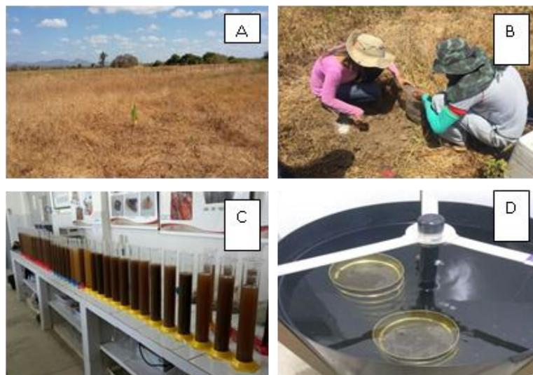
Figura 2. Área da coleta (A); Coleta das amostras (B); Análise das frações granulométricas (C); Análise da estabilidade de agregados (D).
