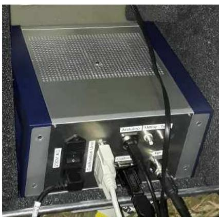
Figura 62 – Parte traseira da unidade de controle. Fonte: comunicação interna da Colaboração BINGO.
