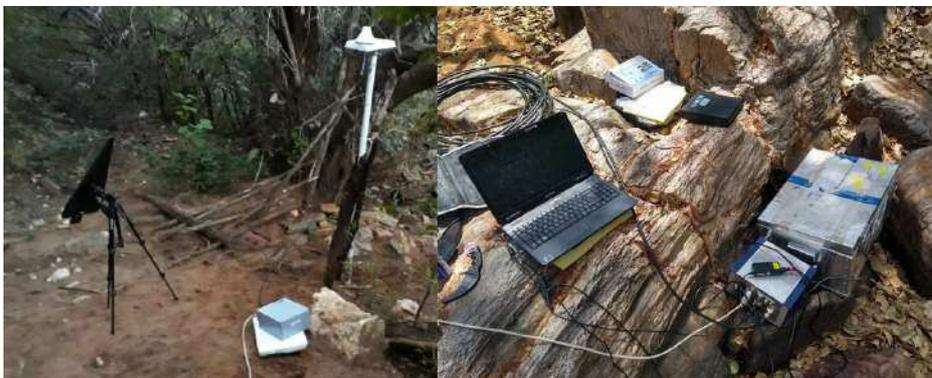
Figura 68 – Montagem experimental com a utilização do espectrômetro Callisto na Serra do Urubu em Aguiar PB. Fonte: produção do autor.
