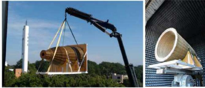
Figura 57 – Esquerda: corneta sendo transportada para dentro da câmara anecoica. Direita: Corneta dentro da câmara anecoica do Laboratório de Integração e Testes (LIT) no INPE [55]. Fonte: [52].
