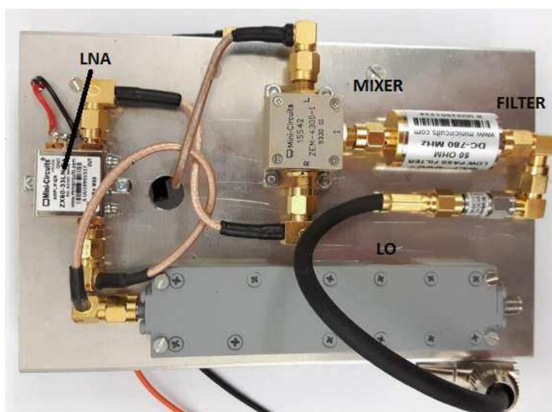
Figura 67 – Conversor heteródino. Hardware de conversor com amplificador, mixer, filtros, cabos e LO na parte traseira. Fonte: comunicação interna da Colaboração BINGO.
