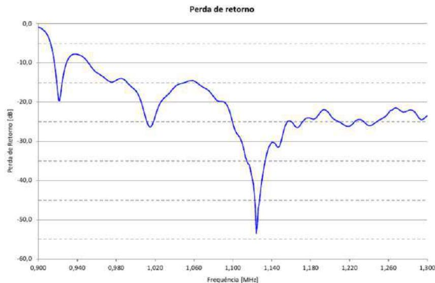
Figura 56 – Diagrama de perda de retorno do protótipo de uma corneta do BINGO. Fonte: [55].
