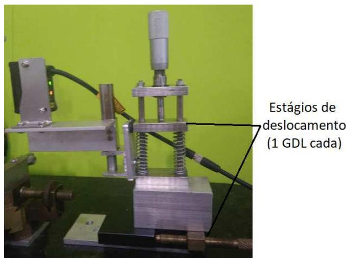
Figura 2.9 – Dois estágios de deslocamento, cada um com 1 GDL, acoplados ao sensor óptico, possibilitando o movimento do sensor nas direções dos eixos  $x$  e  $z$ .
