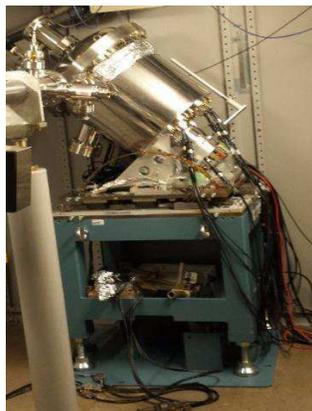
**Figura 3.5.** Câmara de vácuo do conjunto da placa de 1/4 de onda alocada no final da cabine óptica do XDS.
