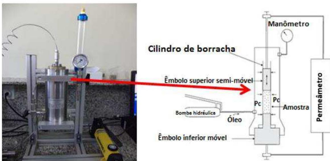
**Figura 21:** Esquema de funcionamento do permeâmetro. **Fonte:** Ribeiro (2014).
