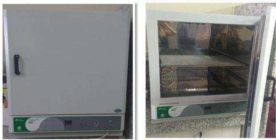
**Figura 25:** Estufa utilizada para secagem das amostras.
