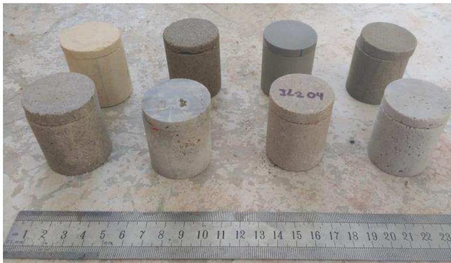
**Figura 24:** Amostras selecionadas para realização dos ensaios elastodinâmicos saturados.
