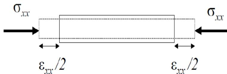
**Figura 9:** Desenho esquemático mostrando a deformação axial causada por compressão axial. **Fonte:** (Dillon e Vasquez., 2000).
