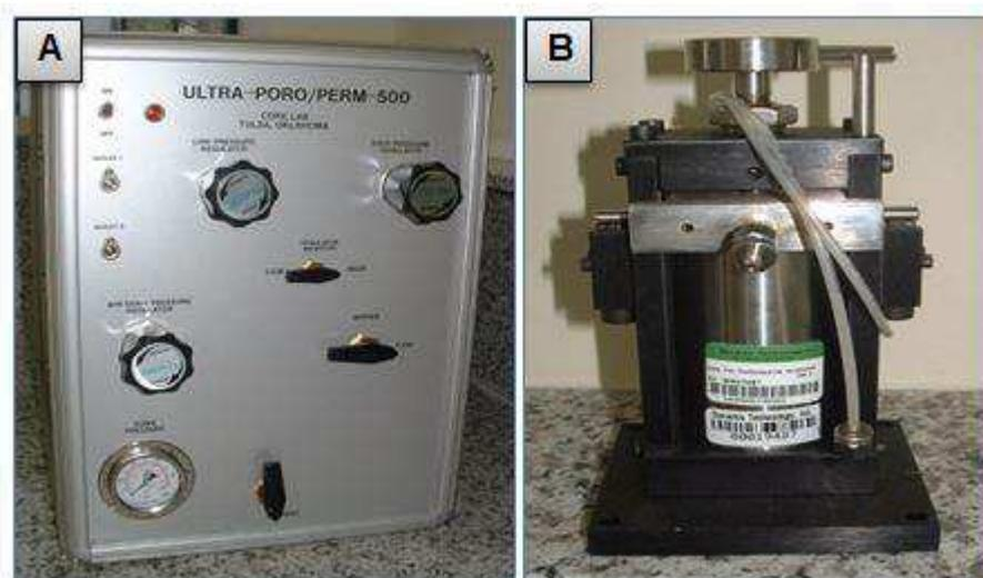
**Figura 19:** Equipamento utilizado para realizar o ensaio de densidade de grãos e porosidade: (a) UltraPoroPerm 500® e (b) Copo matriz.
