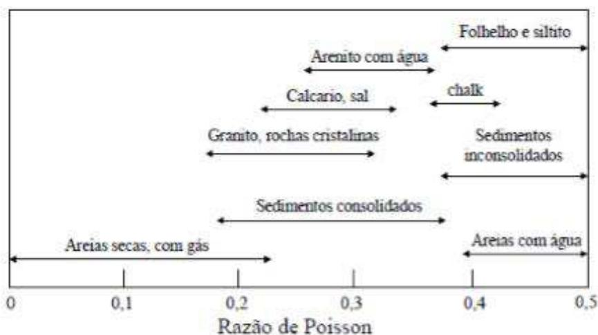
**Figura 52:** Razão de Poisson média para diferentes litologias. **Fonte:** Bourbié *et al* 1987.
