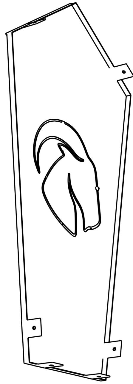
Chapa de aço galvanizado 1,55 mm
