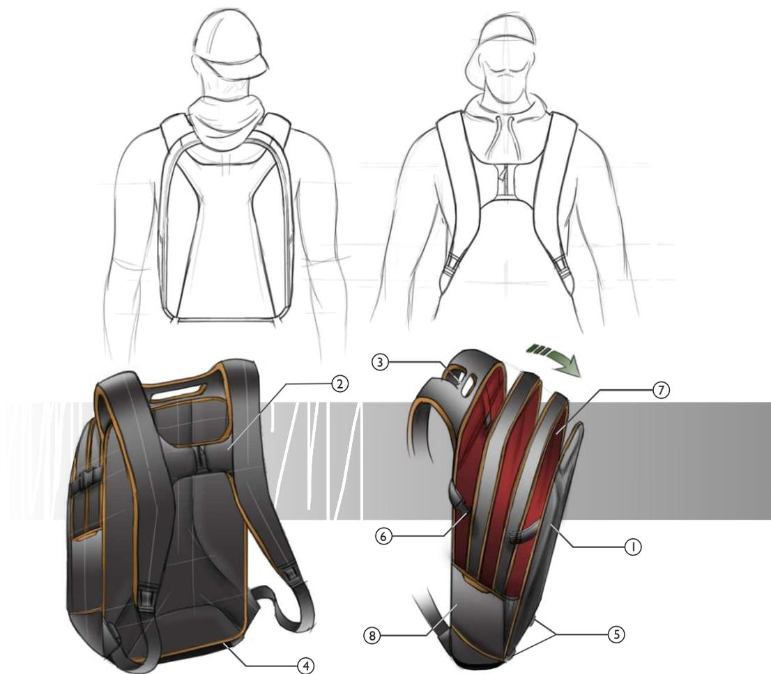
Área de escudo frontal (1), alças projetadas em formato de colete (2) e acoplagem da alça de mão na parte superior (3). Fundo revestido (4) acompanhado de duas fivelas (5) para adição de instrumentos, e mais duas fivelas (6) em cada lateral para segurança anti-furto.
