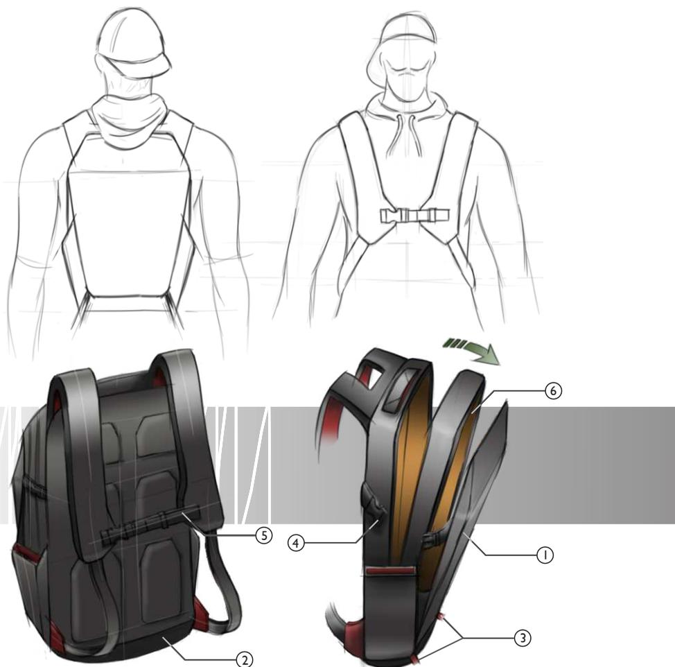
Possui escudo frontal para proteção (1), um fundo revestido (2) acompanhado de duas fivelas (3) para adicionar item que possa ser carregado no exterior da mochila, e mais duas fivelas (4) em cada lateral para segurança anti-furto.
