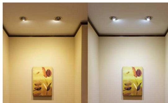
Figura 12: Diferença de iluminação com temperaturas diferentes. À esquerda, branco quente, à direita branco frio.
