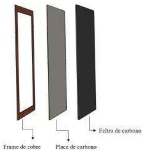
Figura 5 - Esquema 3D da conexão elétrica do eletrodo de feltro de carbono.
