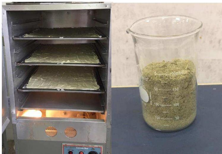
Figura 2. Disposição da camada de espuma de suco misto no secador de bandejas e suco misto em pó.
