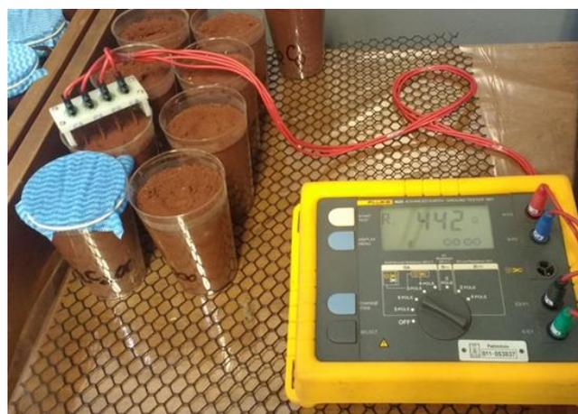
Figura 5. Resistivímetro e arranjo de eletrodos no momento da mensuração de CEa.
