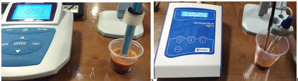
Figura 7. (a) Condutivímetro de bancada realizando mensuração de CE; (b) pHmetro de bancada realizando determinação de pH.
