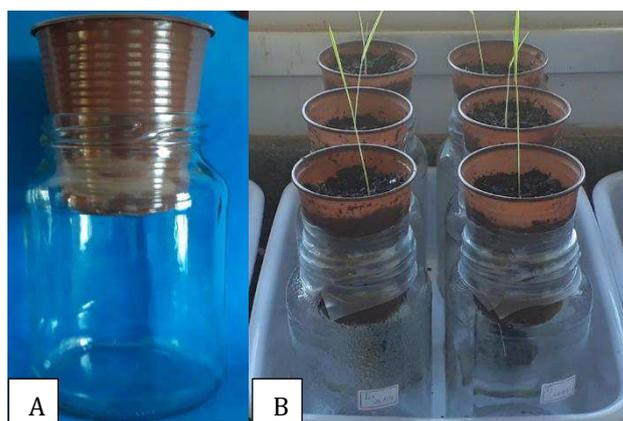
Figura 1. Dispositivo usado para avaliar o efeito dos COVs de isolados de *Cladosporium* spp, na promoção de crescimento nos estádios iniciais de plantas de arroz. (A) Dispositivo sem a placa e a planta e (B) Dispositivos com a placa e a planta.
