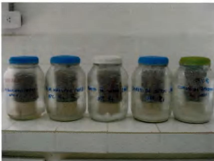
Figura 2.1. Recipiente hermético contendo as soluções salinas e ácidas com as sementes suspensas no seu interior para obtenção das umidades de equilíbrio desejadas.
