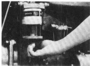
Figura 5. Sangria do sistema de injeção. Fonte: Massey Ferguson (1989).
