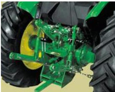
Figura 10. Sistema hidráulico e TDP.
