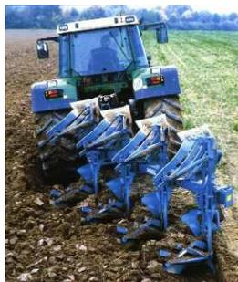
Figura 11. Arado de aiveca montado.
