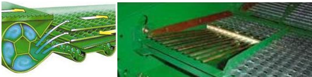
Figura 38. Mecanismo de limpeza.
