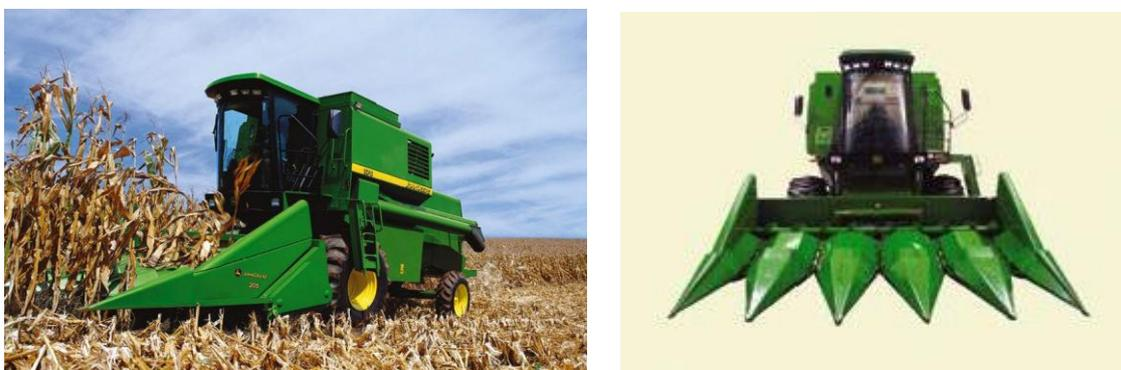
Figura 34. Colhedora de milho e barra de corte.
