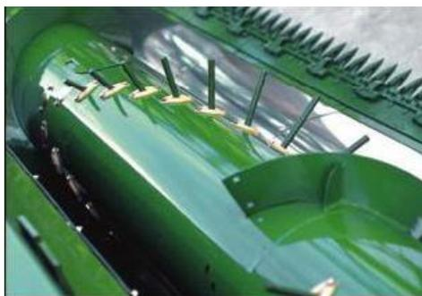
Figura 35. Mecanismo de alimentação.
