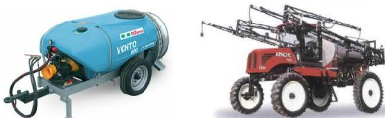
Figura 31. Máquinas de arrasto e montadas.
