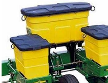
Figura 21. Depósitos de sementes.
