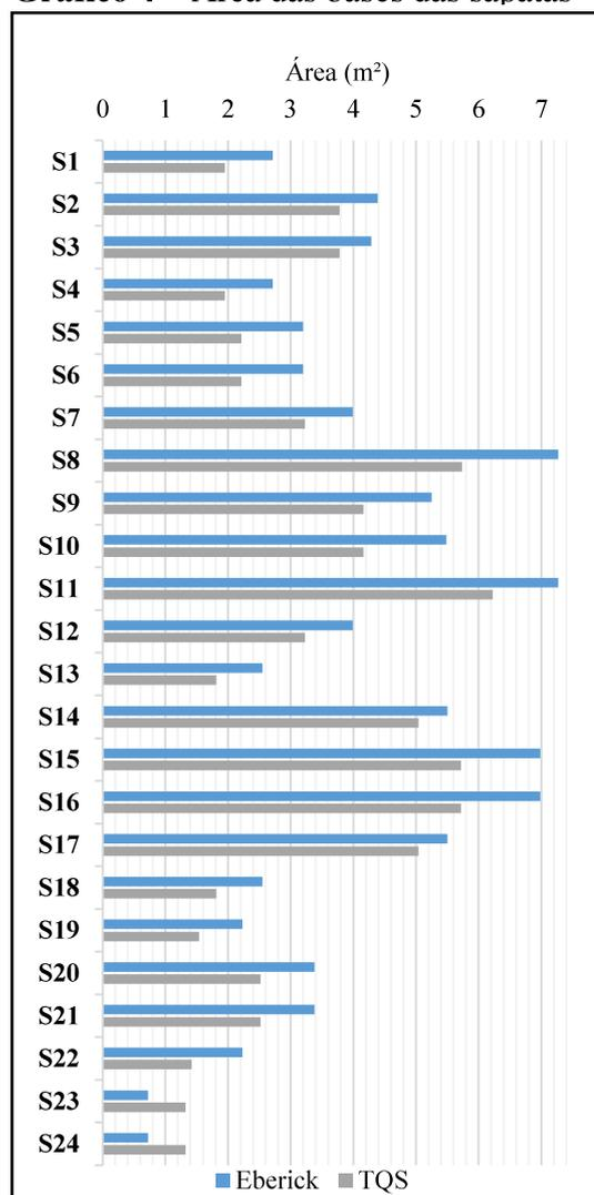
Observa-se a partir dos resultados que a maior diferença entre as áreas das bases das sapatas ocorreu nas sapatas S23 e S24, onde o TQS apresentou uma área de 83,04% maior que em relação ao eberick, conforme visto anteriormente na Tabela 14 do subitem 4.2, essas são as sapatas que recebem os menores carregamentos da estrutura.
