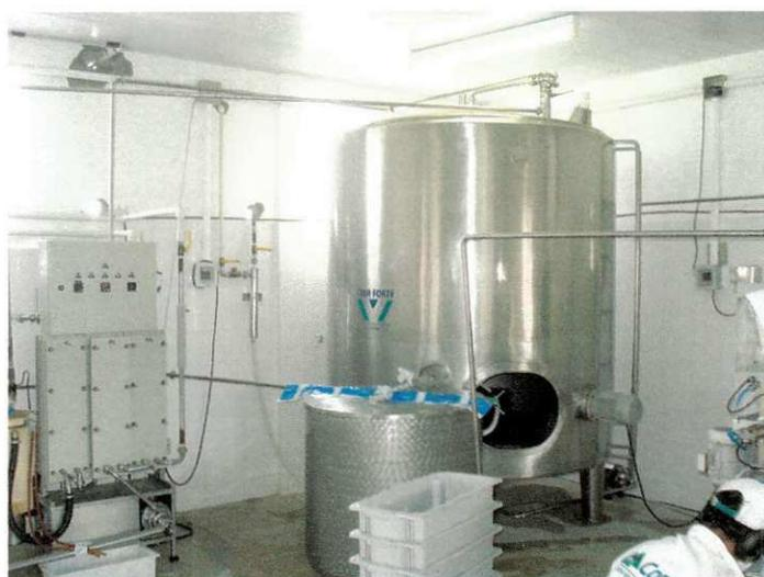
Figura 16 – Tanque de Estocagem 6000L
