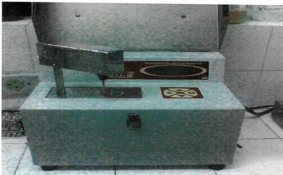
**Figura 5** – Imagem do aparelho crioscópio utilizado para determinar o ponto de congelamento do leite.
