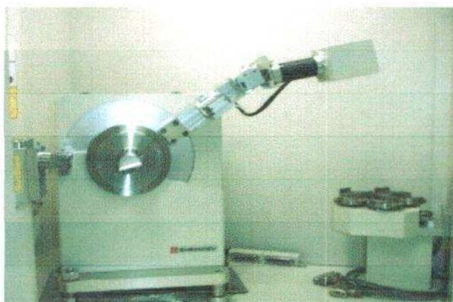
Figura 3.9 - Equipamentos utilizados para realização do ensaio de Difração de raios-X
