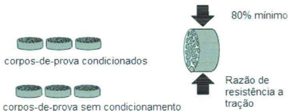
**Figura 2.13 - Layout do procedimento para o ensaio de Lottman [Fonte: TANDON et al., (2003)]**
