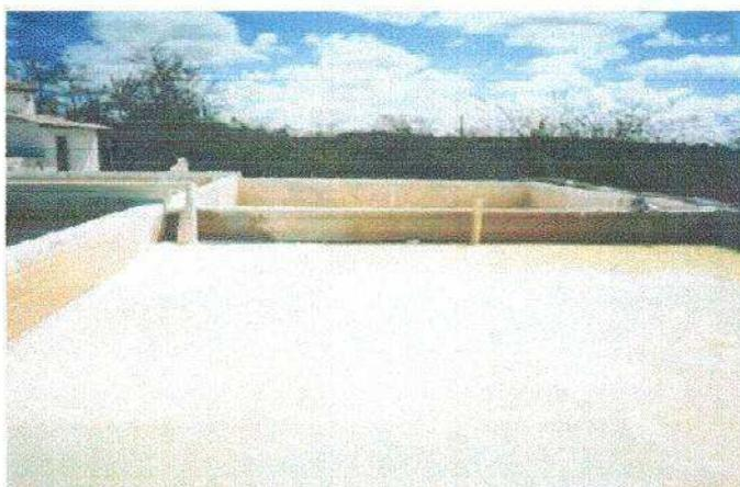
**Figura 2.4 - Tanques utilizados para a decantação e sedimentação do Caulim**
