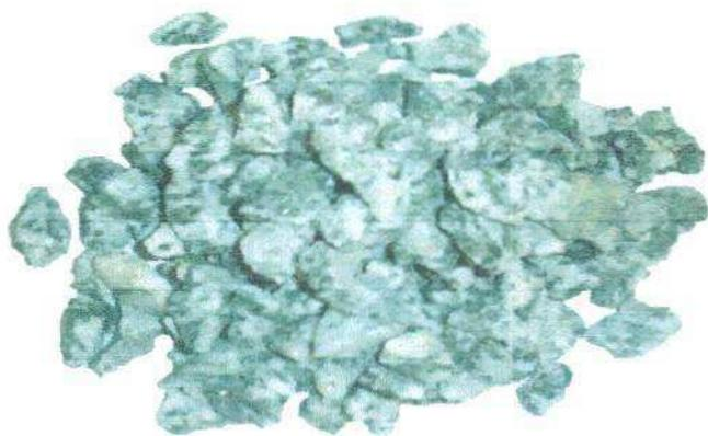
**Figura 3.2 - Agregado de rocha granítica – Brita 19 ou ¾"**
