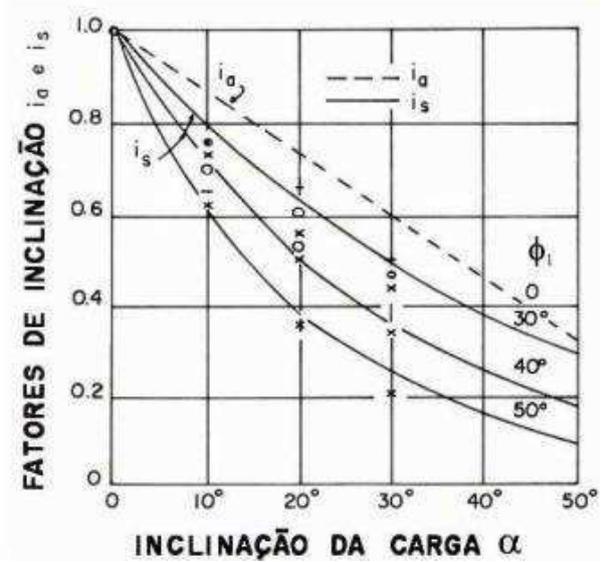
Figura 4 – Fatores de inclinação para resistência ao cisalhamento por puncionamento (MEYERHOF & HANNA, 1978).
