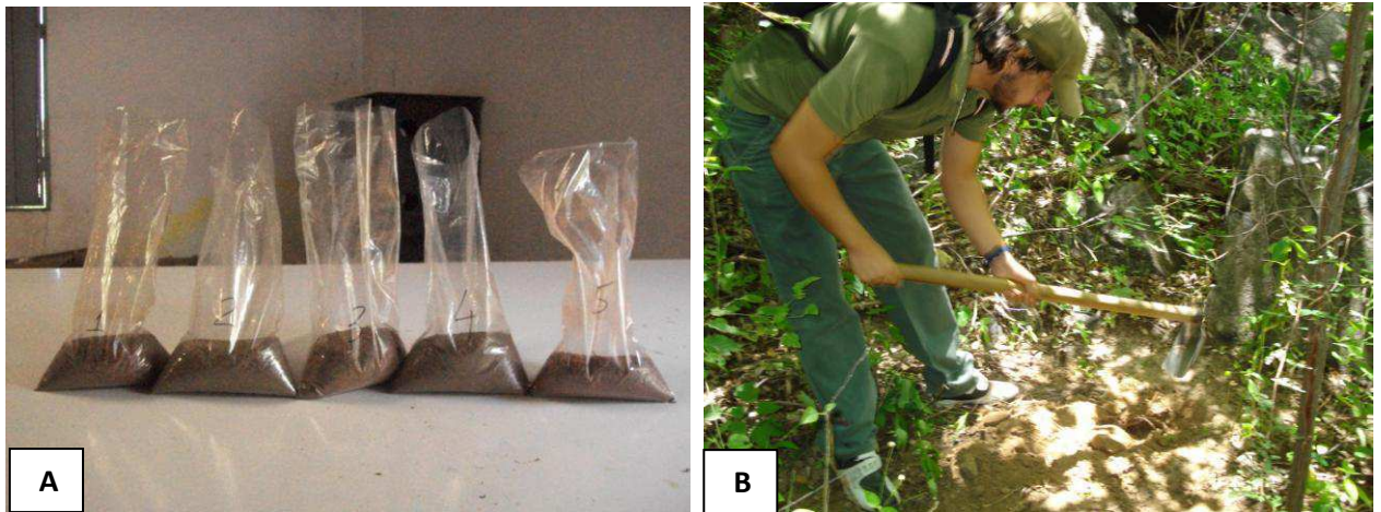
Foto 4 – Amostras de solo (A) coletadas na área pra análise textural (B).
