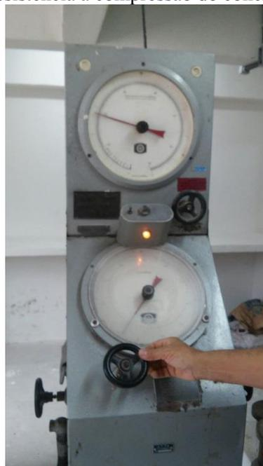
(b) Medidor da força aplicada
