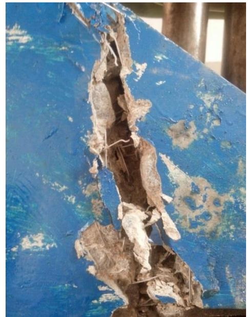
(d) Detalhe das fibras na fissura
