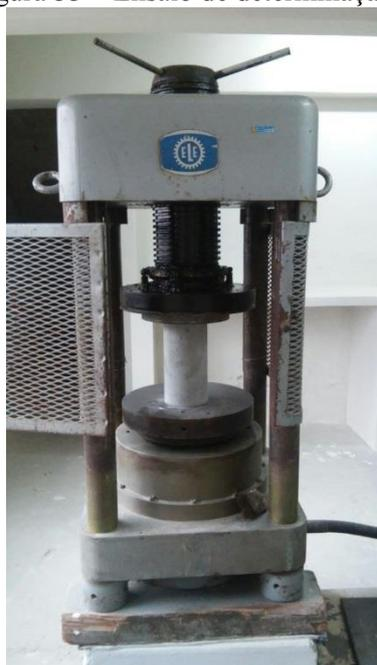
(a) Prensa com o corpo-de-prova
