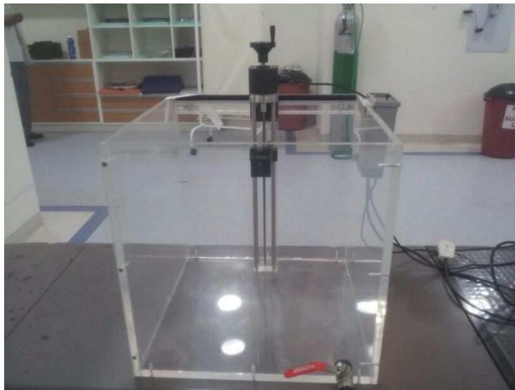
Figura 3.3: Fantoma e suporte com posicionador manual para câmara de ionização.
