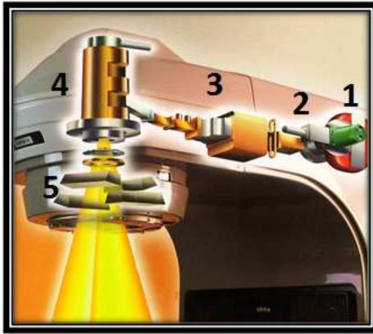
Figura 3.1: Diagrama esquemático de um acelerador linear.
