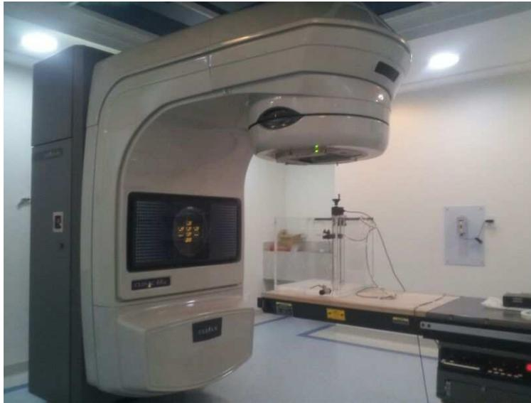
Figura 3.7: Acelerador linear, mesa de tratamento, câmara de ionização e fantoma.
