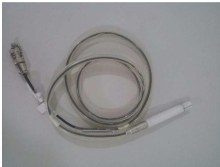
Figura 3.4: Câmara de ionização.
