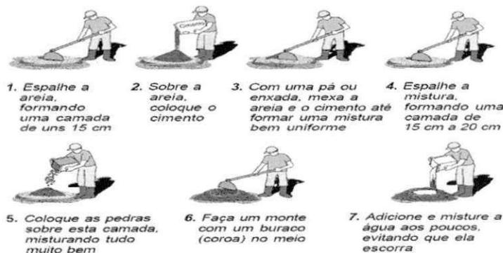
Figura 12: Concreto virado manualmente
