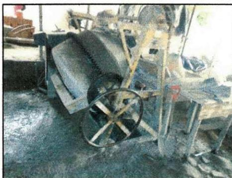
Figura 66 – Betoneira de 580 litros utilizada na obra.
