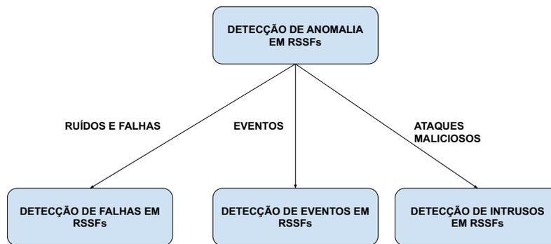
Figura 2.5: Tipos de detecção de anomalias em Redes de Sensores Sem Fio. Adaptado de [5].
