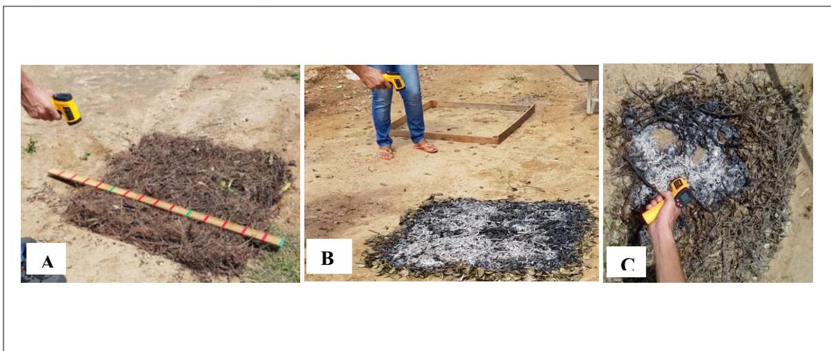
Para a ignição do fogo nas parcelas, usou-se o lança-chamas, devido a sua intensidade, que facilita o processo de ignição e por simular as chamas de um incêndio natural, sendo útil na ação do fogo nos materiais combustíveis como um todo (Figura 9).
