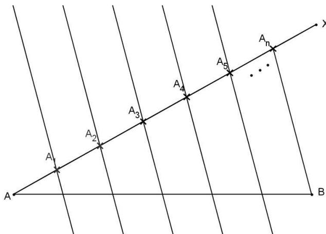
Figura A.4: Divisão do segmento  $AB$  em  $n$  segmentos iguais
