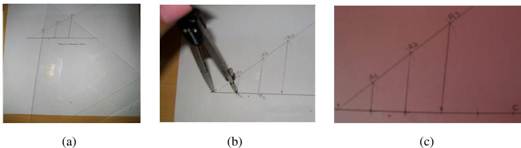
Figura 5.18: (a) Segmentos paralelos ao segmento  $A_3B$ , (b) Marcação do segmento de medida  $\overline{AB_1}$  na reta  $AB$  e (c) Ponto  $C$  marcado sobre a reta  $AB$ .
