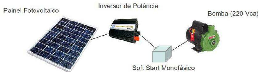
**Figura 3 - Sistema de bombeamento com energia solar**
