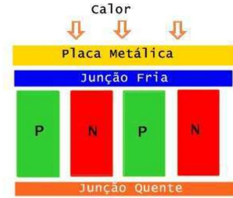
Figura 3.2: Módulo de Peltier com placa metálica
