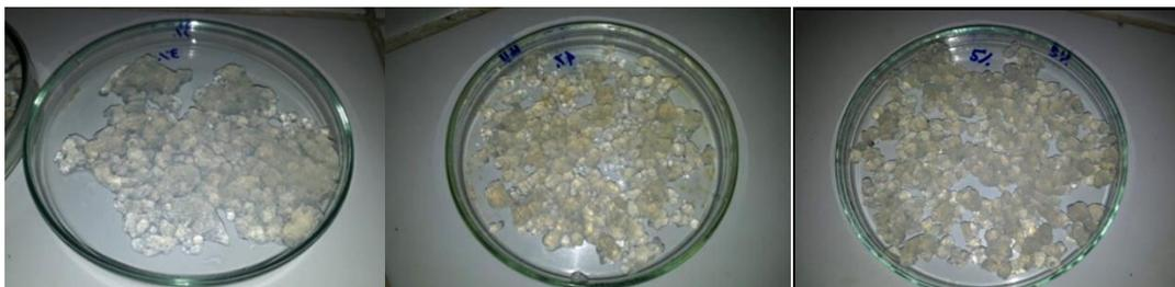
**Figura 1.** Microesferas obtidas após gelificação (sem aplicação de secagem) para pectina cítrica com concentração de 3, 4 e 5% (Da esquerda para a direita).
