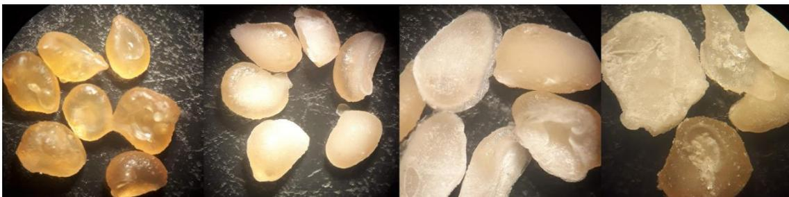
**Figura 3.** Micrografias por microscópio estereoscópio do pectinato de cálcio e dos sistemas microencapsulados. Pectina; UM<sub>1</sub>; UM<sub>2</sub>; UM<sub>3</sub> (Da esquerda para direita).
