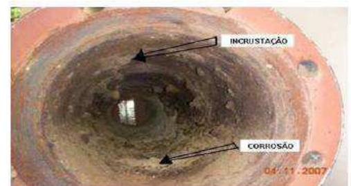
Figura 1.1 – a) Esboço de uma seção transversal de um tubo industrial com a ocorrência dos processos de incrustação e de corrosão (SILVA, LIMA e ROCHA NETO, 2008); b) Fotografia de uma tubulação cedida pela Petrobrás, com ambos os processos (SILVA, 2008).
