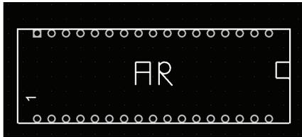
Figura 25 - Componente Arduino no P-CAD.
