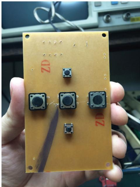
**Figura 46** - Face frontal da PCB2 fabricada.
