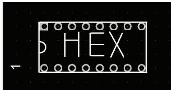
Figura 29 - Componente HEX4050BP no P-CAD.
