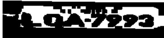
Figura 28: Figura 17 após dilatação e erosão
