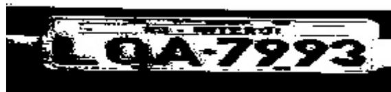
Figura 17: Imagem após a equalização e o *threshold*
