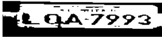
Figura 27: Figura 17 após dilatação
