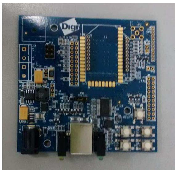
Figura 3: Fotografia do adaptador USB XBee/XBee-PRO 802.15.4
