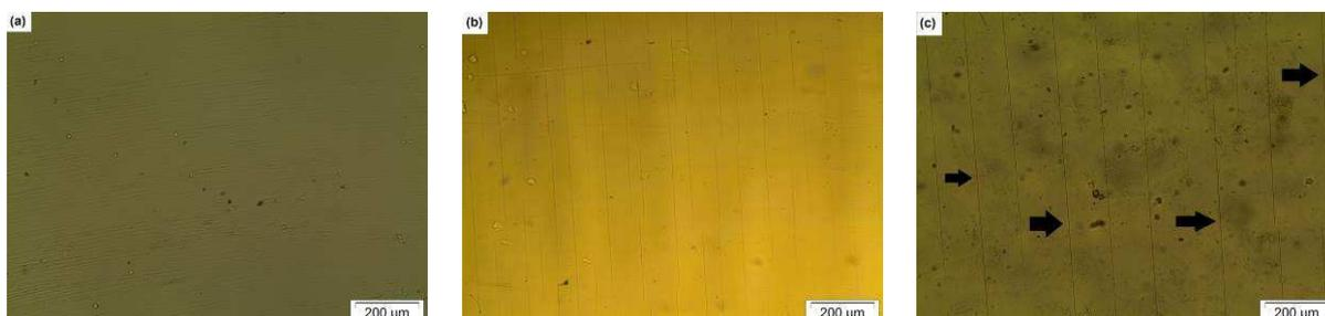
Figura 56 - Micrografias obtidas por MO das superfícies do PS, para: (a) 0; (b) 30; e (c) 60 dias, respectivamente.
