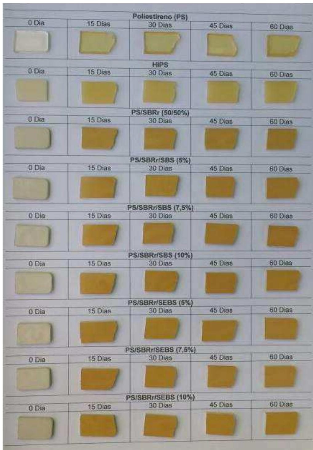
Figura 52 - Evolução do envelhecimento fotodegradativo do PS, HIPS, da blenda binária e das misturas ternárias.
