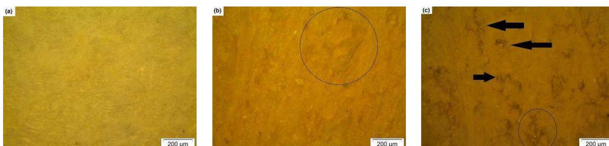
Figura 58 - Micrografias obtidas por MO das superfícies da blenda PS/SBRr, para: (a) 0; (b) 30; e (c) 60 dias, respectivamente.
