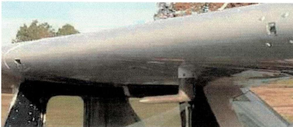
**Figura 15** – Tubo de Pitot em asa de avião.
