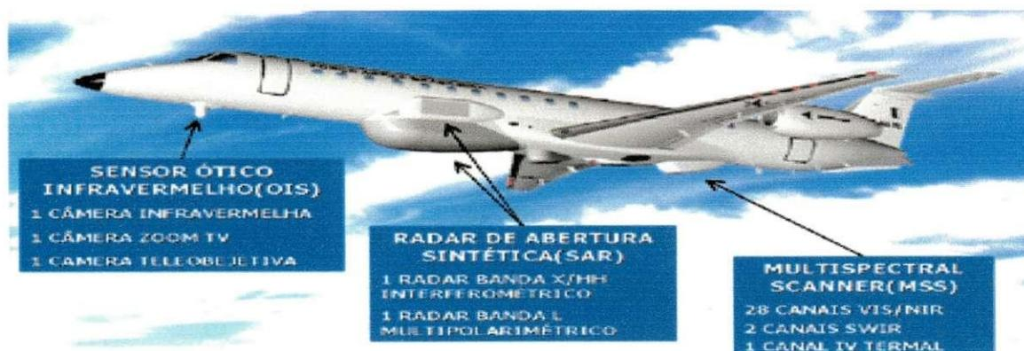
**Figura 21** - Aeronave equipada com Sensores.
