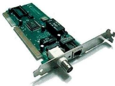
Figura19- Placa de rede Ethernet com conectores BNC e RJ-45
