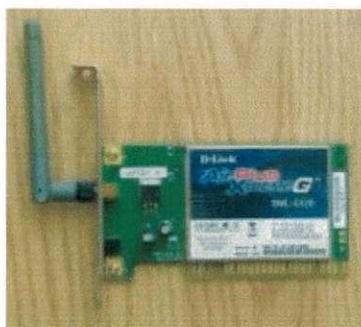
Figura18- Adaptador de rede PCI com tecnologia Wi-Fi
