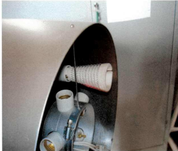
Figura 4.7 - Resistência paralela à direção do fluxo de ar sem incandescência.
