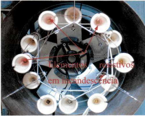
Figura 4.9 - Pontos de incandescência nos centros dos cones.
