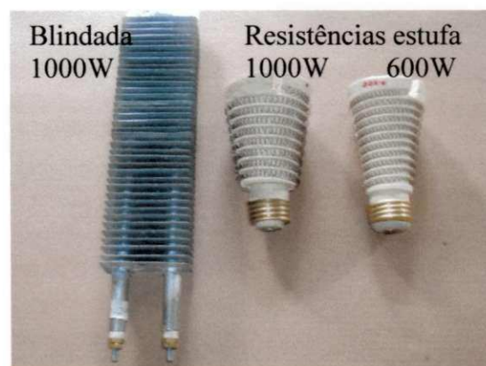
Figura 3.26 - Resistência blindada de 1000W, ao lado de resistências tipo estufa de 1000W e 600W.
