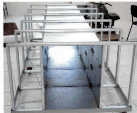
Figura 3.12- Vista superior do módulo do secador.
