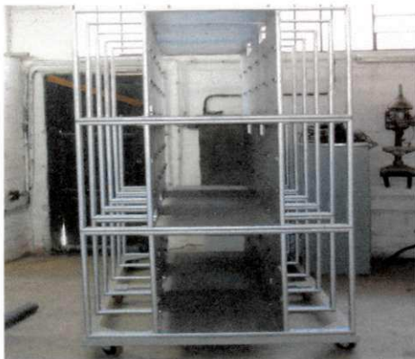
Figura 3.11 - Estrutura do secador com os três módulos sobrepostos.
