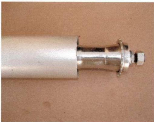
Figura 3.17 - Cubo dianteiro de bicicleta semi-inserido no tubo de 50 mm.
