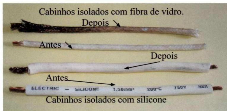
Figura 3.67 - Cabinhos submetidos aos testes de temperatura.
