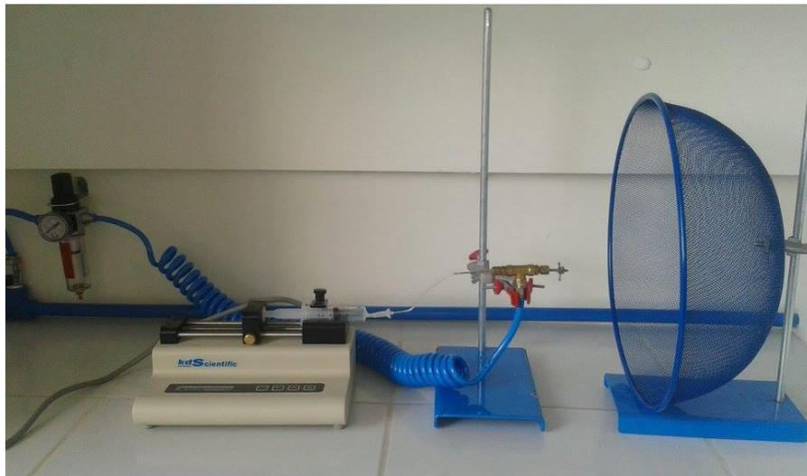
Figura 7 - Fotografia do sistema utilizado na técnica de SBS para fiação a temperatura ambiente.
