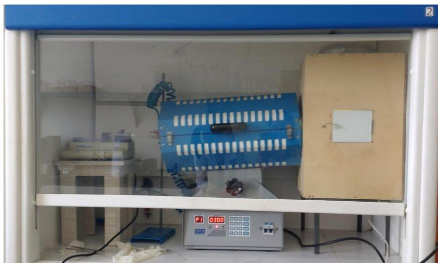
Figura 9 - Fotografia do sistema de SBS adaptado com o forno tubular e coletor dentro de câmara aquecida.
