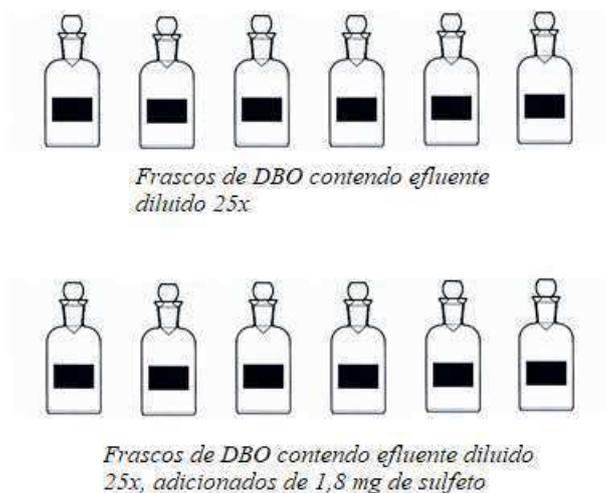
A água de diluição foi utilizada para diluir o efluente 25 vezes já que a amostra possuía ainda uma concentração de matéria orgânica, sendo portanto, necessário tal diluição para possibilitar uma concentração residual de oxigênio dissolvido - OD ao final do teste. Essa diluição foi realizada seguindo o mesmo método do preparo de DBO (APHA – 5210 A, 2012).
