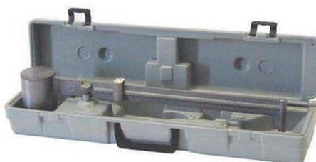
Figura 11 – Balança de lama modelo 140 – Fann.
