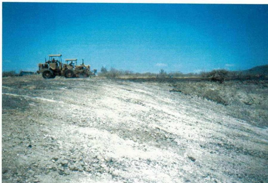
FIGURA 9 – OPERAÇÃO DE DECAPEAMENTO DA MINERAÇÃO LAGES.
