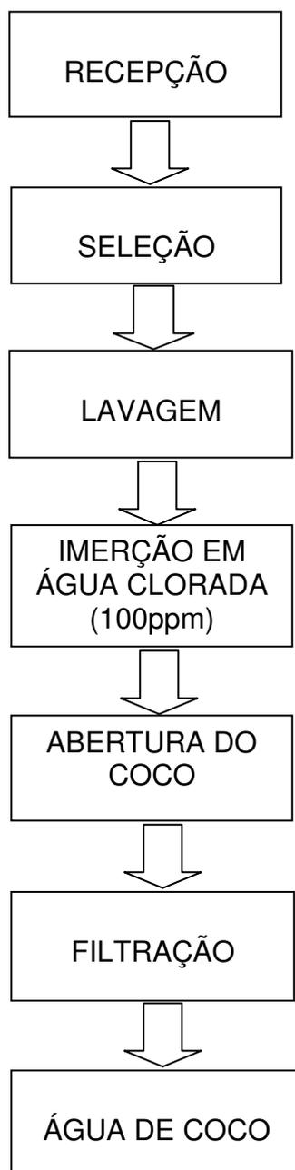
**Figura 2.** Fluxograma de obtenção da água de coco utilizada na formulação da bebida. FONTE: elaboração própria, 2012.
