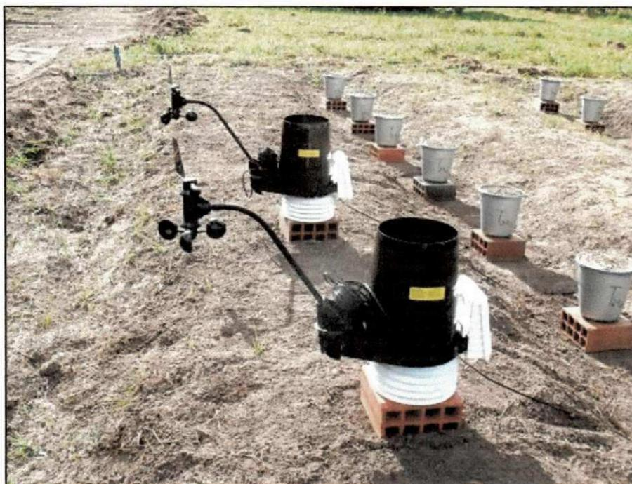
**Figura 38 – Processo de calibração entre as duas estações meteorológicas**
