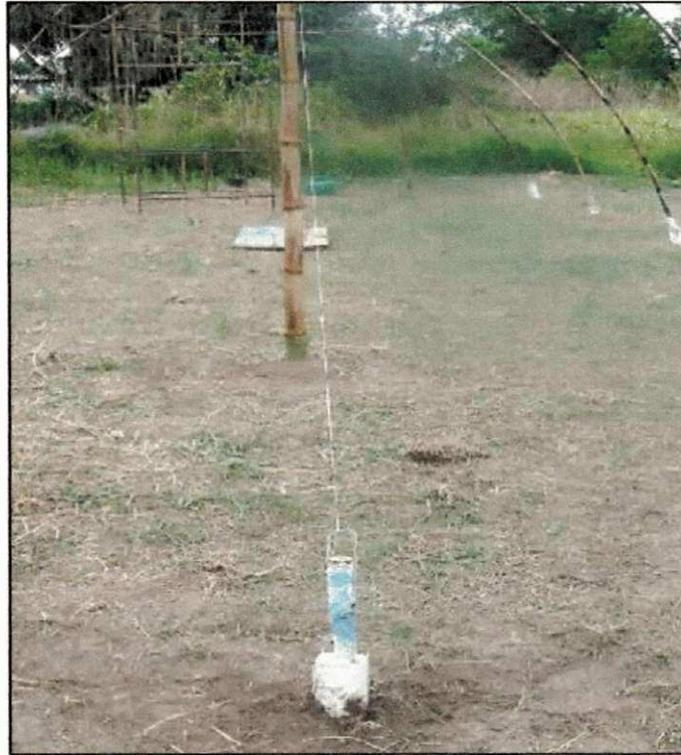
**Figura 22 - Amarrações com náilon para evitar balanço na estrutura causada pelo vento**
