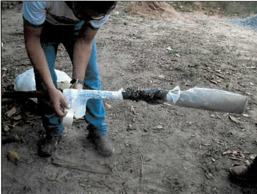
**Figura 23 - Revestindo os bambus com sacola plástica e fita adesiva**
