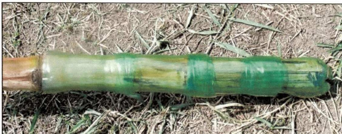
**Figura 24 - Garrafas PET sendo usada no revestimento do bambu**
