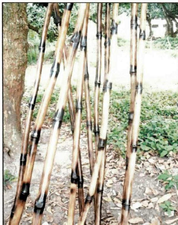
**Figura 20 - Bambus após o tratamento**
