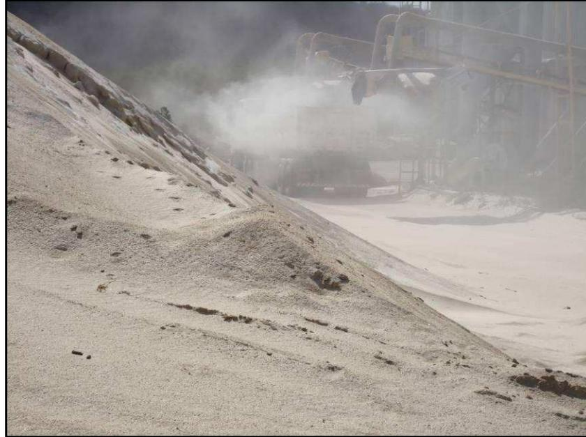
Figura 7 – Armazenamento irregular do sienito processado.
